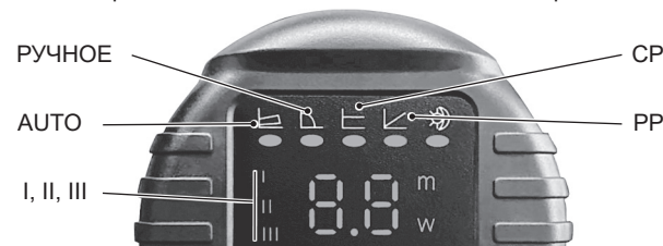
Рисунок 6. Световые индикаторы работы насоса
